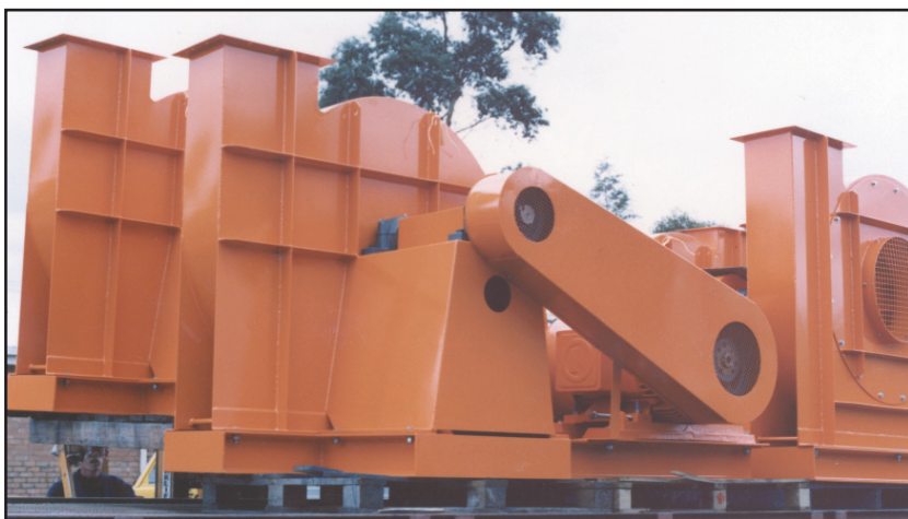
MVW 360 Fans, Arr. 1, 75kw
